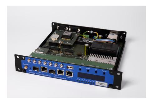
Сервер разработан и производится России. Используются модули GPS/ГЛОНАСС российской разработки (НАВИС и НАВИА), открытое программное обеспечение (ОС Linux) и программы с отрытым исходным кодом или собственной разработки.
