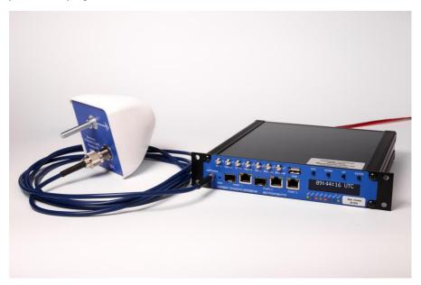
Два порта Ethernet 100/1000Base-Т(медь), или 100Base-FX(оптика, SFP, опция), или 1000Base-X(оптика, SFP) поддерживают синхронизацию по протоколам IEEE 1588-2008 (РТР v2, аппаратная поддержка), NTP и SNTP. Третий порт 10/100/1000Base-T может использоваться для синхронизации по NTP и SNTP. Порты могут быть подключены к отдельным изолированным подсетям. Поддерживается протокол резервирования PRP.
